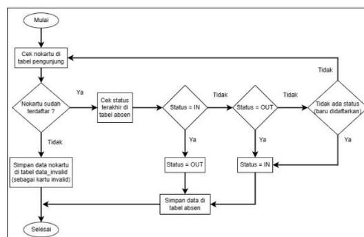
Gambar 2. *flowchart* saat melakukan scan kartu
