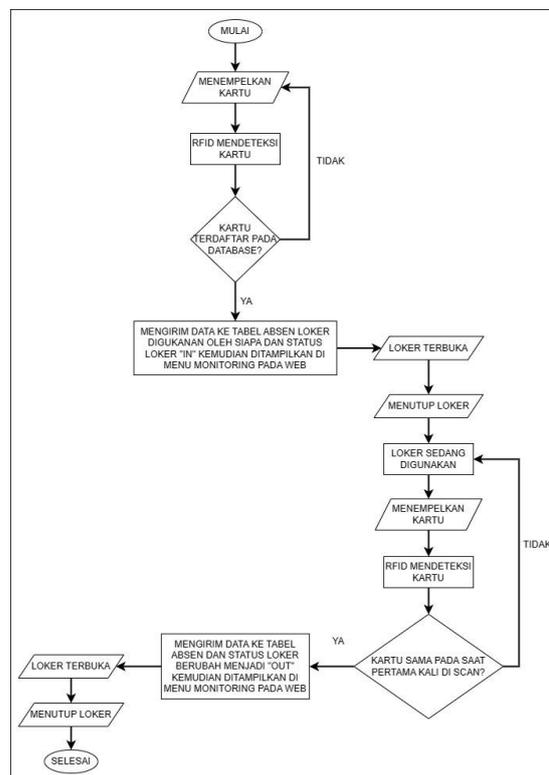
Gambar 1. *Flowchart* pada loker
